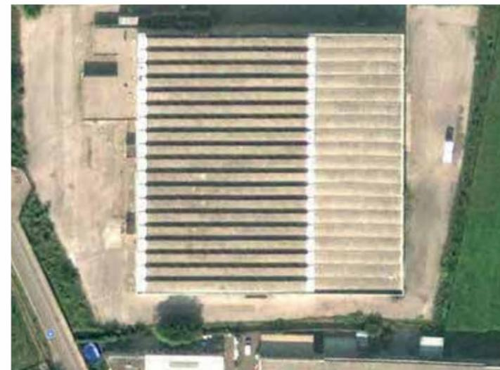
**Conversione di una copertura di un edificio produttivo realizzata con lastre di cemento amianto in parte a shed, in parte a tegoli curvi in nuova copertura con coibentazione termica e manto continuo di tipo sintetico a vista.**
