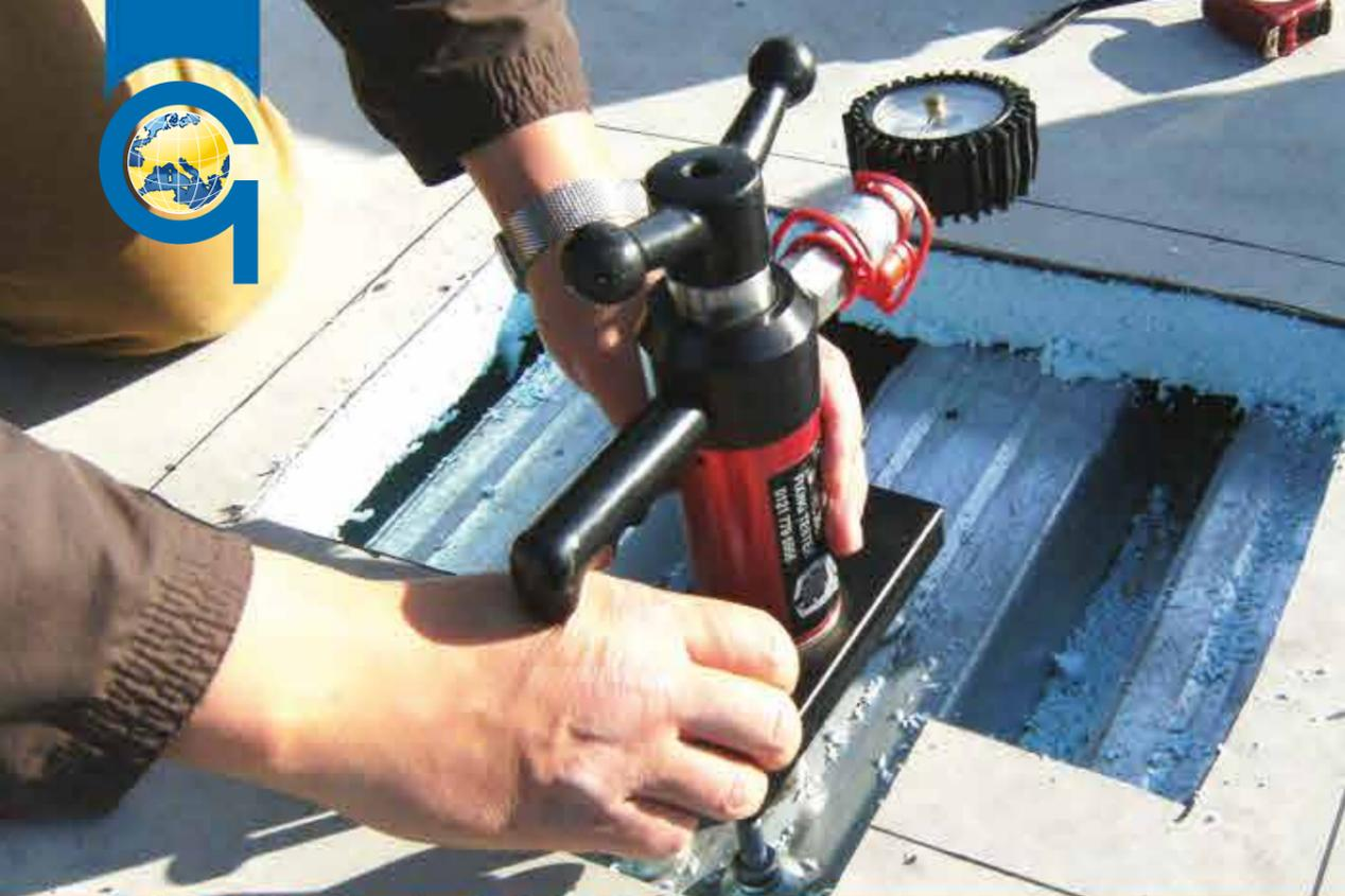
Prove di estrazione dei sistemi di fissaggio meccanico delle coperture
